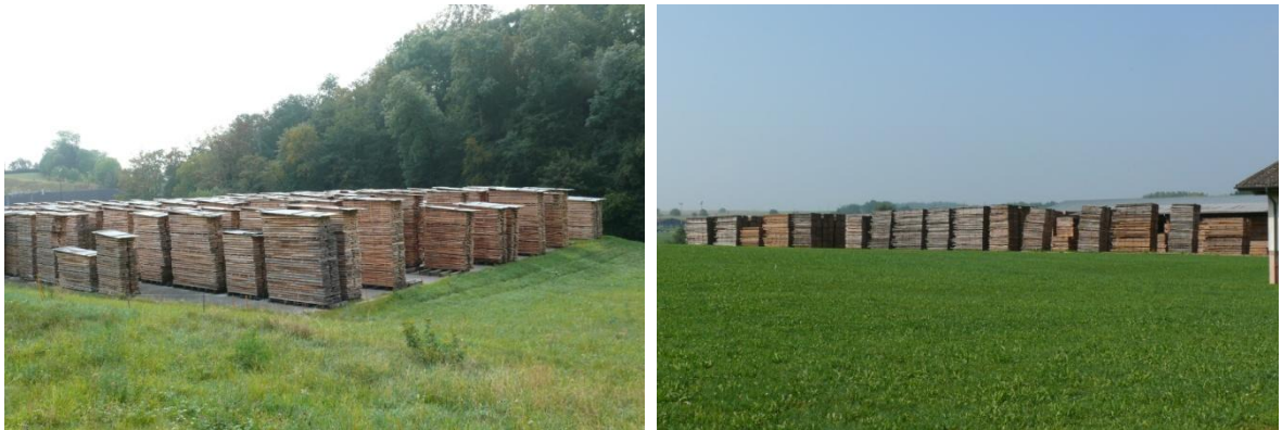
Abb. 29: Enormer Platzbedarf zur Lufttrocknung von Laubhölzern
